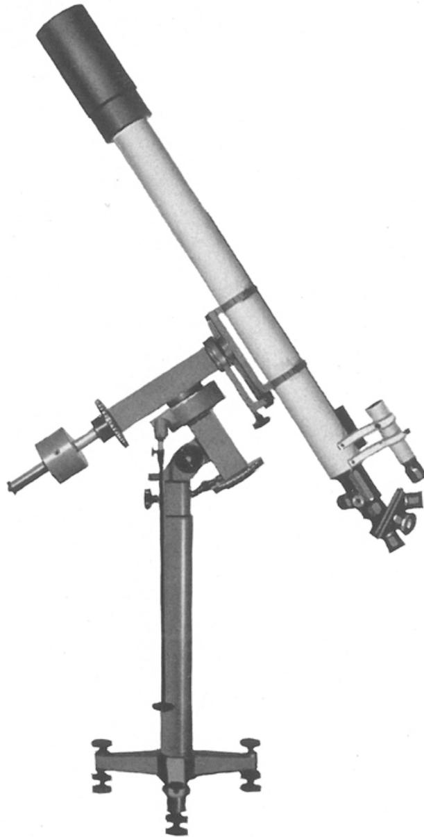
Butenschön Refraktor 90/1200mm, parallaktisch montiert auf ASTRONOM II V
