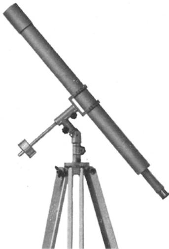
Für den Anfänger wurde ein klassischer **Fernrohrbausatz „60/800“** (**Abb. 3**, links) neu in das Programm aufgenommen. Er bestand aus einem achromatischen Objektiv 60/800, einem Huygens Okular  $f = 15\text{mm}$  und Rohrschellen aus Pertinax. Eine passende Montierung mit der Bezeichnung **„ASTRONOM O“** ohne Feinbewegungen und Teilkreise sowie ein höhenverstellbares **Dreibeinstativ** komplettierten als optionales Zubehör das Angebot.
