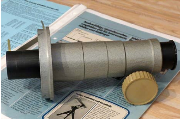
Abb. 14: Kosmos Okularauszug aus eigener Produktion einer der Fließbänder von KK für kleine Refraktoren, ca. 1965, Quelle: Paech "Bastelkeller"
